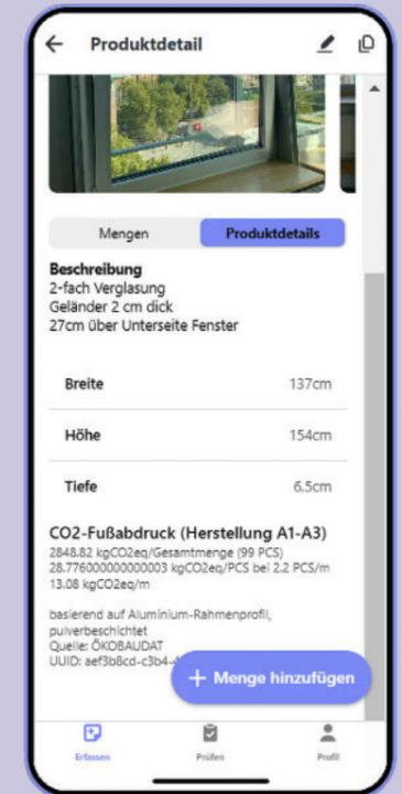
Abbildung 5.7: Beispielhafter Prozess zur Erstellung eines digitalen Bauproduktpasses (Screenshots aus der Concular Audit-App)
