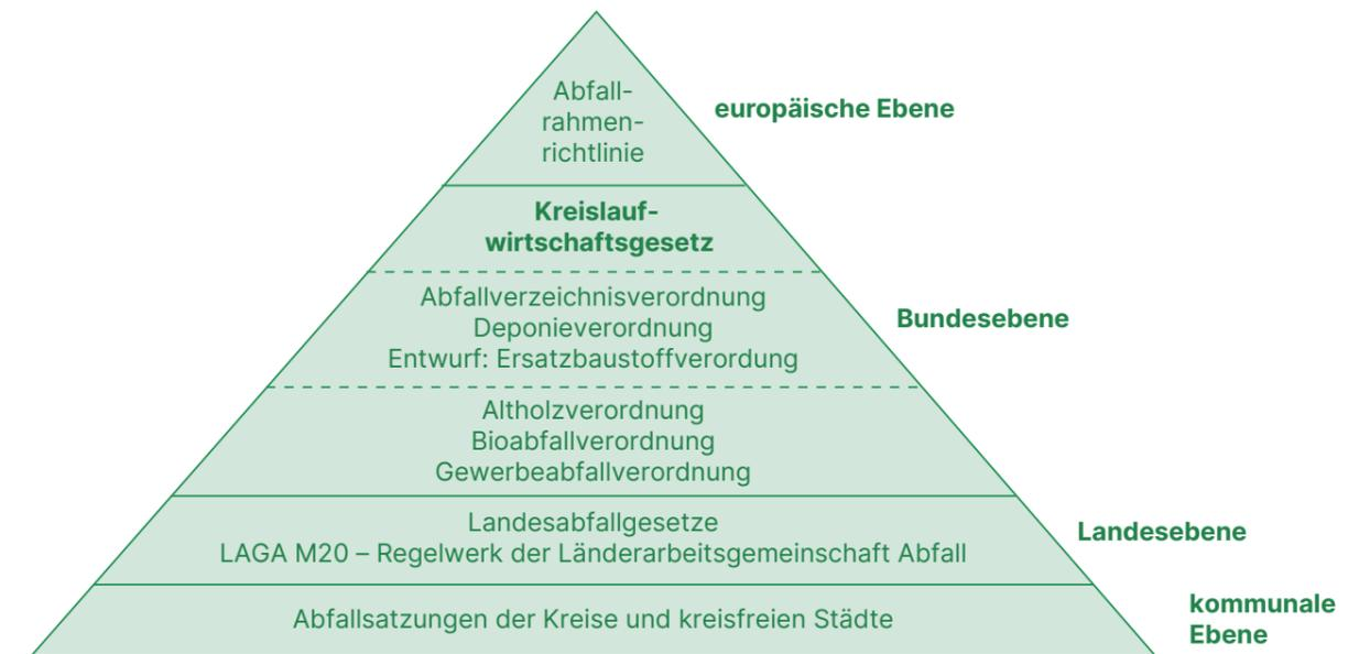
Abbildung 2.1: Ebenen des Abfallrechts mit Relevanz für Rückbau und Recycling im Bauwesen (Abbildung nach <sup>14)</sup>)
